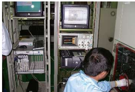
温度試験(恒温槽によるテスト)
