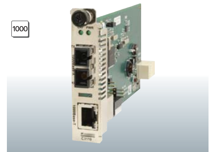
型番: C3110-1013 標準価格: ¥102,000 リンクバジェット: 8.5dB LAN(RJ45) ⇔ 1ポート 1000Base-T 光 ⇔ 1000Base-SX 850nm マルチモード SC 220m/550m
