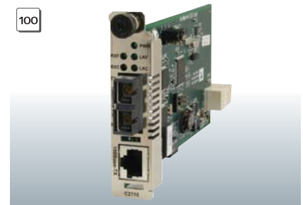
型番: C2110-1013 標準価格: ¥46,000 リンクバジェット: 11.0dB LAN(RJ45) ⇔ 1ポート 100Base-TX 光 ⇔ 100Base-FX 1300nm マルチモード SC 2km
